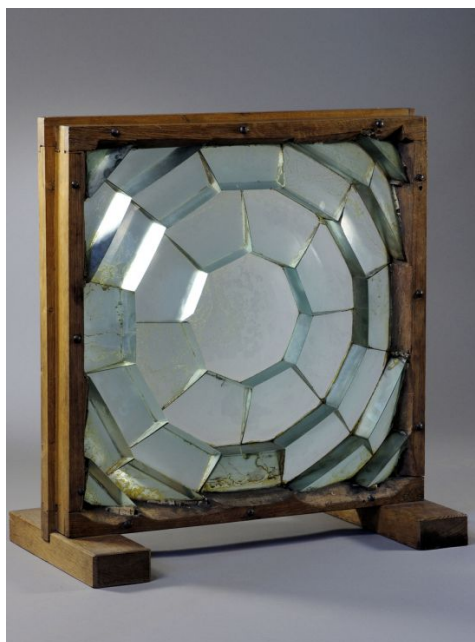
FIGURE 3 – Prototype de lentille à échelon présenté à la Commission des phares le 31 octobre 1820 (OBSPM 2020 , collections de l'Observatoire de Paris).
