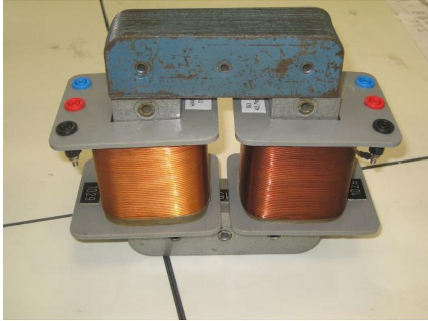
Un transformateur est réalisé par le bobinage de deux circuits filiformes orientés autour d'un cadre de fer doux qui canalise -presque- tout le champ magnétique. Ce noyau de fer est bien souvent feuilleté afin d'éviter les courants de Foucault en son sein (et donc les "pertes fer").
