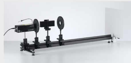
Expérience avec le miroir de Lloyd à l'aide d'un laser He-Ne
