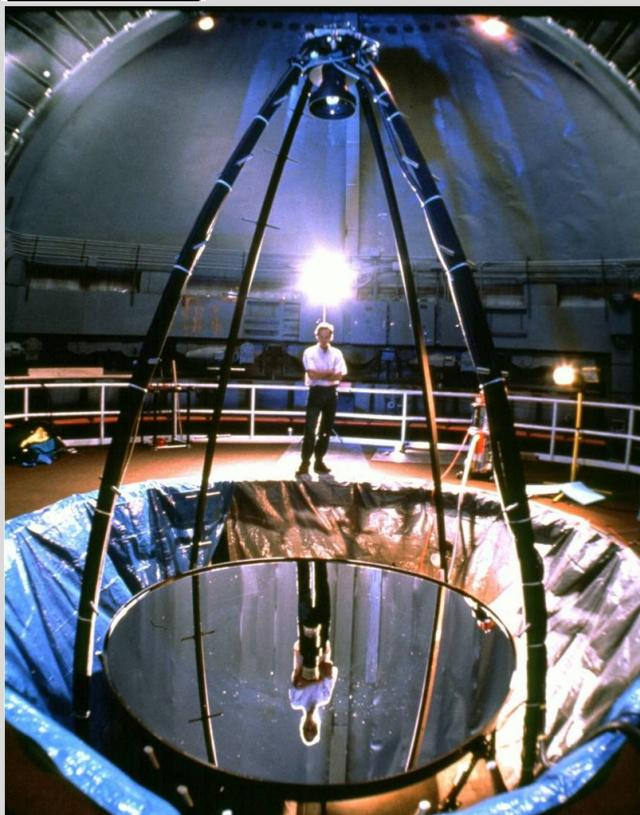
Un télescope à miroir liquide (TML) est un télescope dont le corps réfléchissant est un liquide. L'idée d'utiliser un liquide en rotation pour créer une parabole parfaite est parfois attribuée à Isaac Newton mais les difficultés techniques étaient insurmontables avant la fin du XIX<sup>e</sup> siècle.
