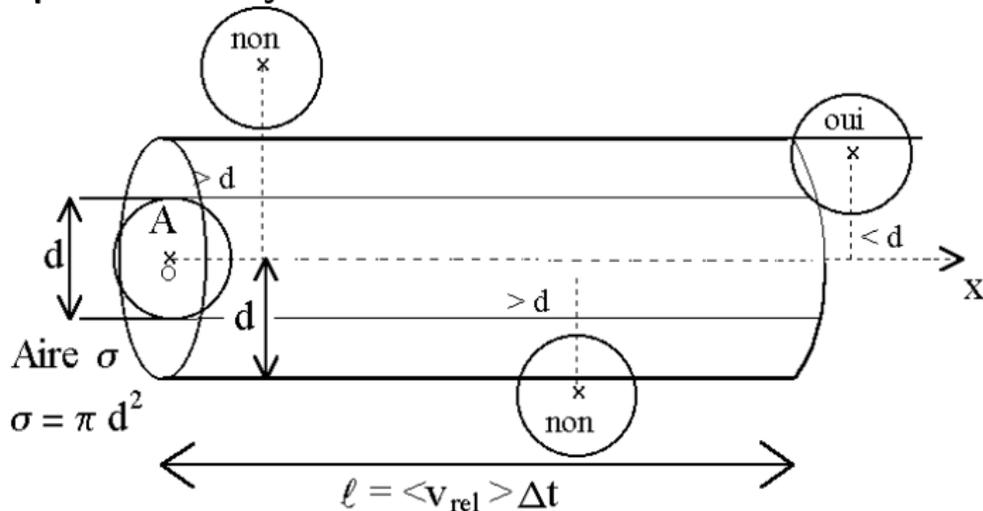
une particule assimilée à une boule se déplace de  $l$  avant d'entrer en collision avec une autre particule.
