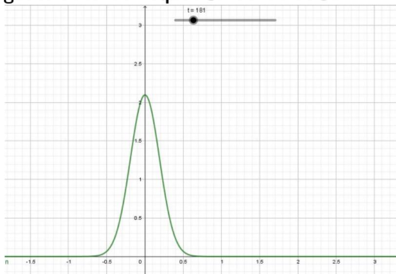
La distribution de particules initialement disposées en  $x = 0$  est une gaussienne dont la largeur augmente au cours du temps.
