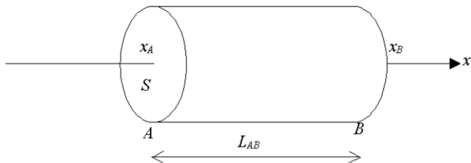
une tige homogène, de section constante  $S$ , de longueur  $L_{AB}$ , fermée sur ses surfaces latérales, mise en contact avec deux milieux en  $x_A$  et en  $x_B$ , en régime permanent ( $\frac{\partial}{\partial t} = 0$ ).
