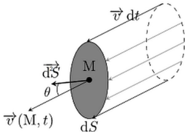
Les particules de vitesse  $\vec{v}$  qui passent à travers la surface  $d^2S$  sont celles présentes dans le cylindre de longueur  $v dt$ .
