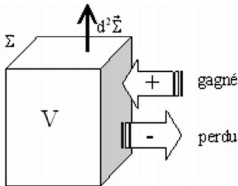
une surface fermée. On introduit un signe moins dans les bilans car les conventions de l'analyse vectorielle et de la thermodynamique sont différentes.
