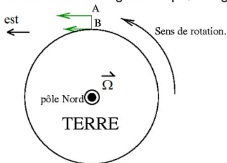
La vitesse horizontale du mobile se conserve donc. Or, la vitesse initiale dans le référentiel géocentrique  $R$  supposée galiléen est non nulle et plus importante que celle du sol (en B), plus proche de l'axe de rotation.
