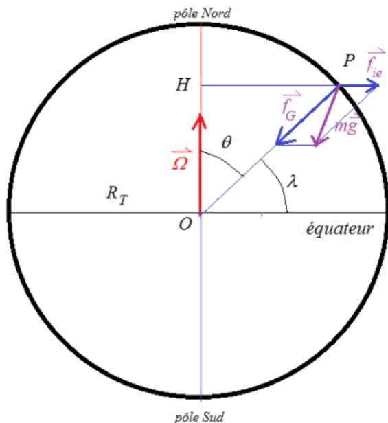
$\vec{f}_G = -G \frac{m M_T}{R_T^3} \overrightarrow{OP}$  et  $\vec{f}_{ie} = m \Omega^2 \overrightarrow{HP}$ . La direction indiquée par un fil à plomb est celle de  $\vec{g}$ . Elle ne passe pas *a priori* par  $O$ .
