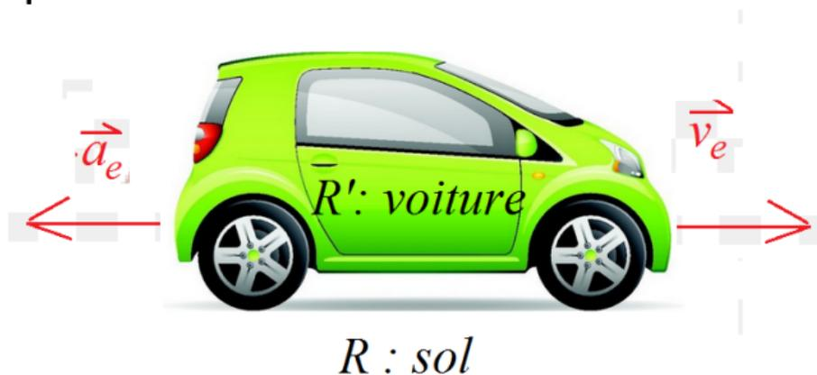
une voiture (le référentiel  $R'$ ) qui est en translation rectiligne dans le référentiel ( $R$ ) du sol ( $\vec{v}_e = +v(t) \vec{u}_x$ ), mais qui freine :  $\vec{a}_e = -a \vec{u}_x$ . La force d'inertie d'entraînement "pousse" les passagers vers l'avant du véhicule.
