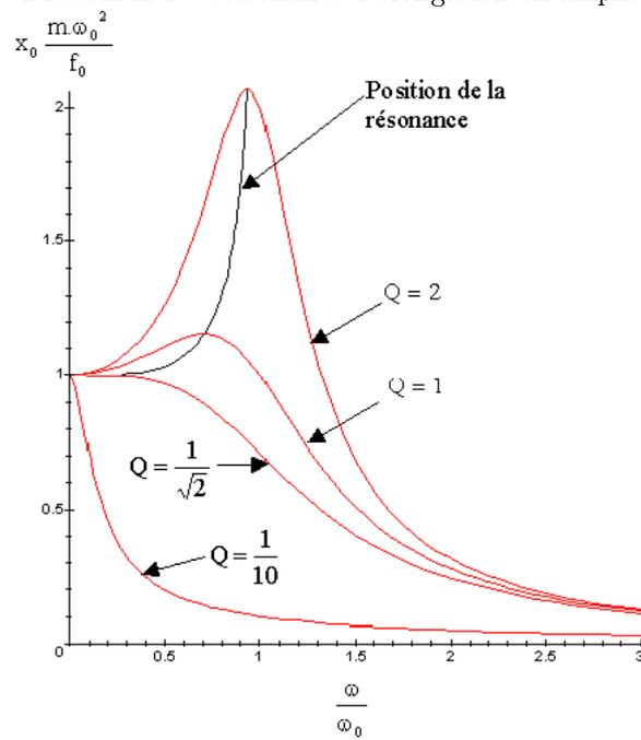
FIGURE H.7 – Résonance d'élongation en amplitude
