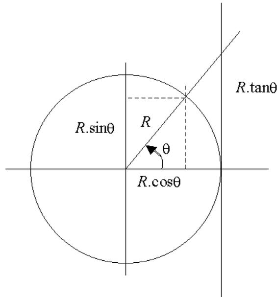
FIGURE B.1 – Définitions géométriques des grandeurs trigonométriques
