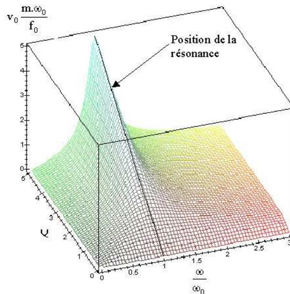
FIGURE H.2 – Résonance de vitesse en amplitude
