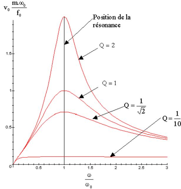
FIGURE H.3 – Résonance de vitesse en amplitude
