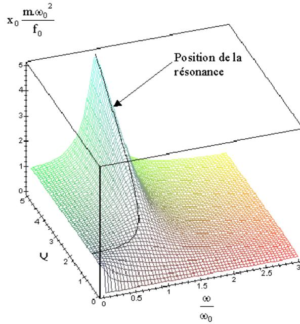
FIGURE H.6 – Résonance d'élongation en amplitude
