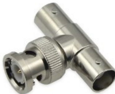
raccord 3 BNC : « T » « bouchon » 50 \Omega (résistance sur BNC)
